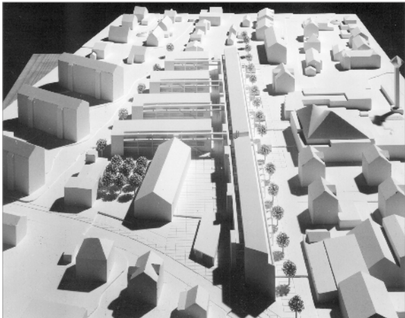
Das Zentrum der Überbauung bildet der Platz, mit dem bestehenden Gebäude und der langgezogenen Erschliessungsgasse. An dieser Erschliessungsgasse befinden sich alle Gemeinschaftsräume, Gewerbe und Dienstleistungsräume, Ateliers und alle Hauszugänge der 11 Häuser. Die Wohnasse öffnet sich zwischen den Hauszeilen auf die Grünräume mit der Spielwiese und die Familiengärten. (Modellsicht)
